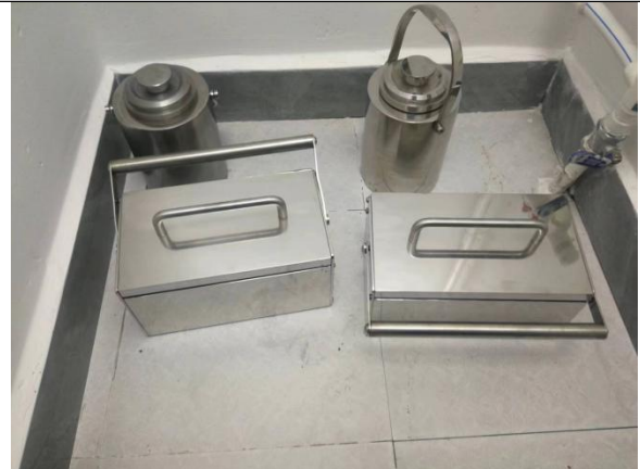
储源铅罐、转运防护盒等
