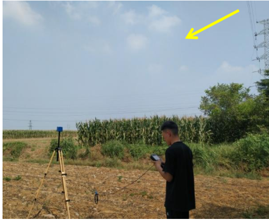
B7: 110kV 丰苗线 46#塔~47#杆塔之间双回电缆衰减
